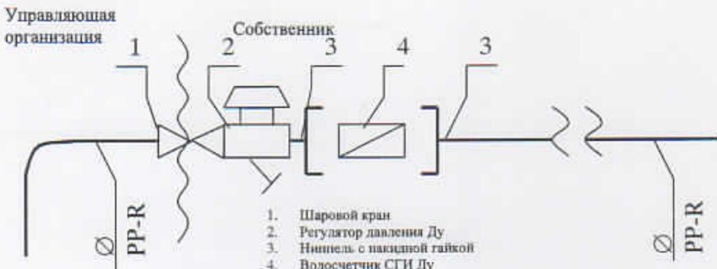
Исполнитель несет ответственность за надлежащее состояние и работоспособность систем горячего и холодного водоснабжения согласно вышеуказанной схеме до волнистой линии слева (включая шаровой кран).
