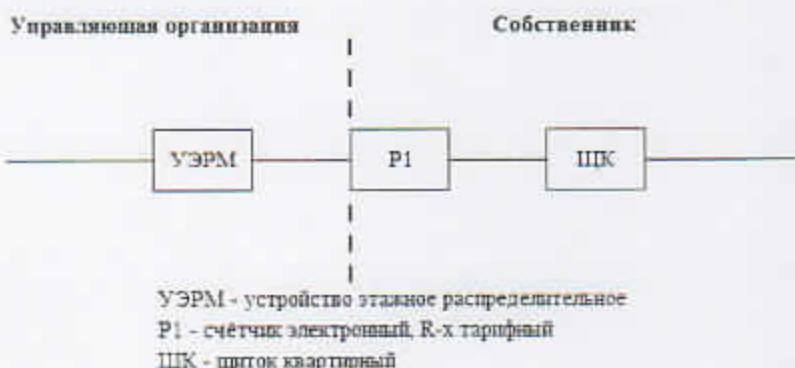
Исполнитель несет ответственность за надлежащее состояние и работоспособность питающих электрических сетей на квартиру согласно вышеуказанной схеме до прибора учета (пунктирной линии слева).
